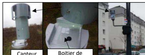
Figure 131 : Capteur Sigma-2 pour la mesure des PM10
